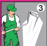
**3** Обработайте основание грунтовыми составами БОЛАРС, соответствующими Вашему типу поверхности.
